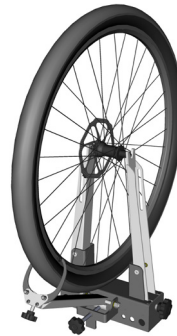
der Zentrierständer ist zur Anwendung vorbereitet
